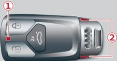
Fig. 31 Çelësi i baterisë: Çmontimi i mbajtëses së baterisë
