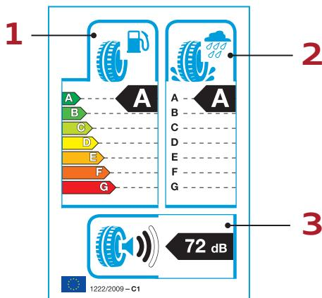
**1 Efikasnost potrošnje goriva.** Otpor kotrljanja gume utiče na efikasnost potrošnje goriva. Što je otpor kotrljanja manji, to se više štedi goriva i manje je zagađenje sa CO<sub>2</sub>.
