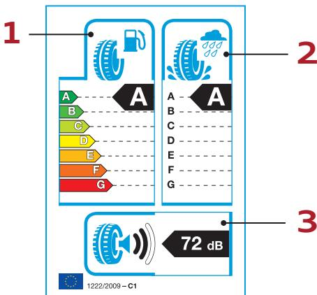
**1 Efikasnost potrošnje goriva.** Otpor kotrljanja gume utiče na efikasnost potrošnje goriva. Što je otpor kotrljanja manji, to se više štedi goriva i manje je zagadenje sa CO<sub>2</sub>.
