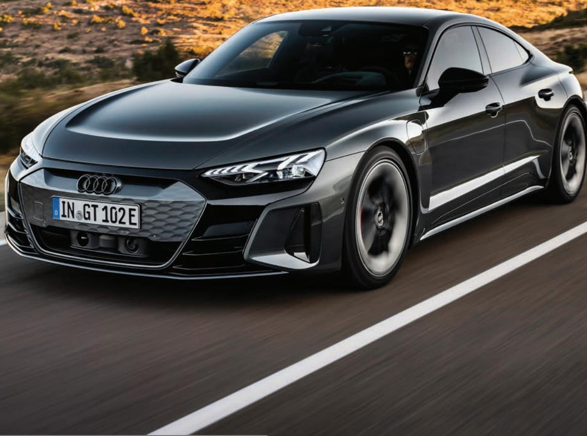
Gran turismo je sportsko touring vozilo sa odličnim dinamičnim upravljanjem, kao pouzdana jedrilica. Audi e-tron GT baš je takvog karaktera. Ovisno o modelu, izlazna snaga elektromotora je 350 kW (476 KS) ili 440 kW (598 KS), što omogućuje i dinamične skokove. Bitno je istaknuti i domet do 487 kilometara (prema WLTP ciklusu vožnje) koji je omogućen baterijom neto kapaciteta od 85 kWh. 800 V tehnologija baterije omogućuje brzo DC punjenje izlazne snage do 270 kW.
